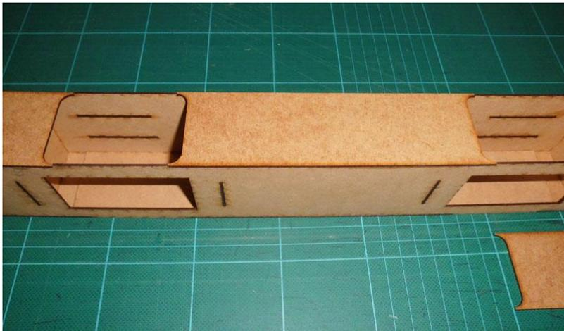
Eine Stützleiste wird entlang der senkrechten Dach-Struktur geklebt.
