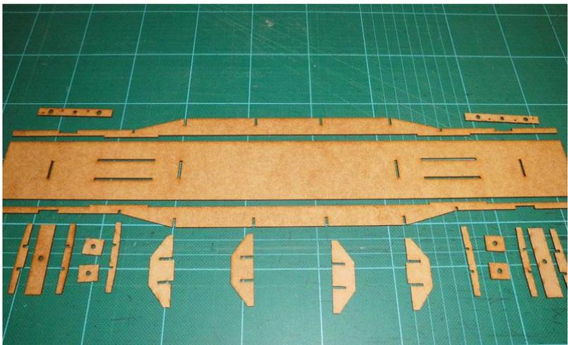
Auf die Bodenplatte werden in der Mitte die Innen Längsträger geklebt in die Aussparungen von der Bodenplatte.
