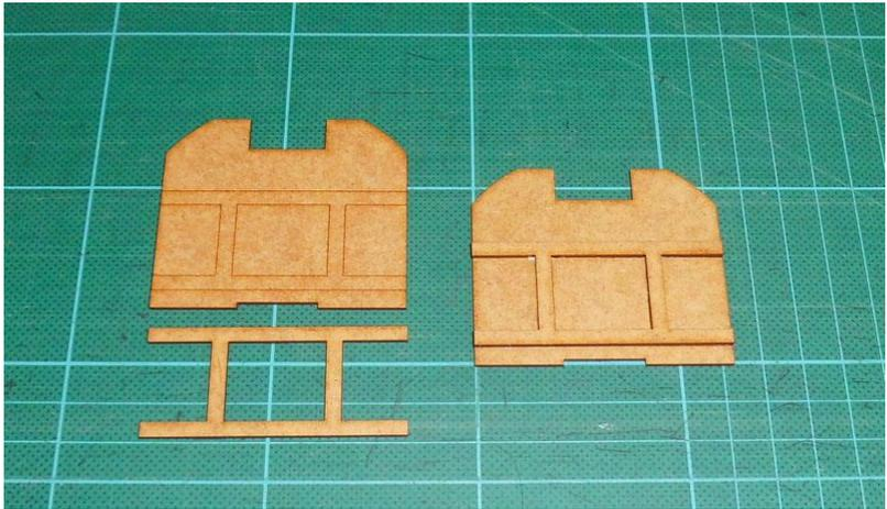
Für den Gehäusebau werden vorerst die Querspannen auf die Bodenplatte geklebt.
