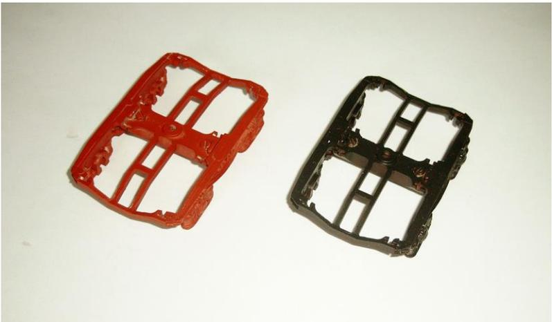
Die Radsätze werden in Delrin Gleitlager geschoben und in die Drehgestelle montiert.
