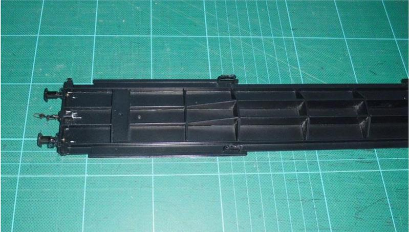
Anbei teilweise die ausgelaserte Gehäuseteile, wobei die Türe separat eingesetzt werden.
