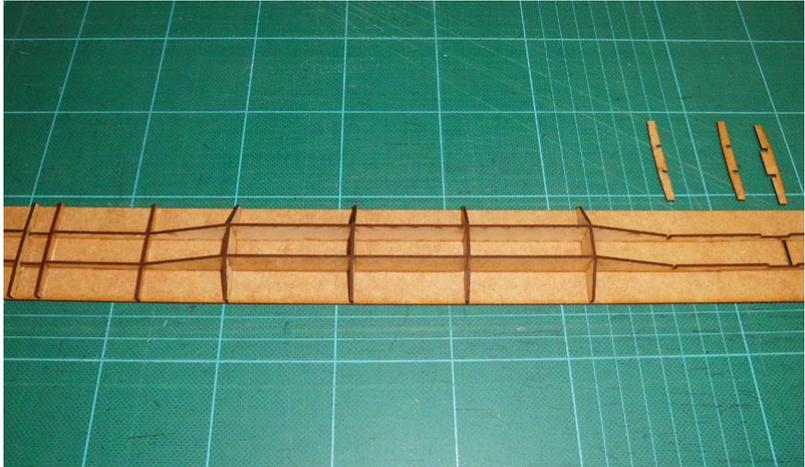
Die Stützplatten für die Drehgestell Zapfen werden zwischen die Längs-und Quer-Trägern geklebt.
