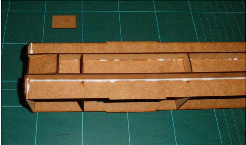
Jetzt werden die 3 Gehäuse Seitenteile auf das Gehäuse Rahmen und den beiden Stirnseiten geklebt. Nachdem werden die Tür- Stützen hinter geklebt.
