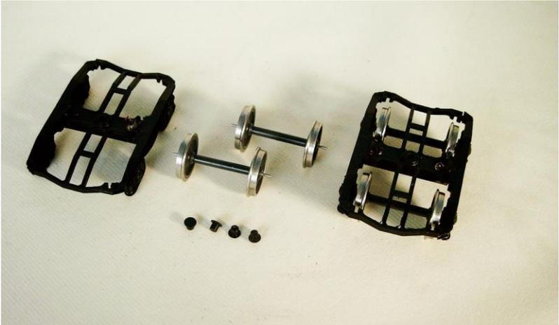
Die Drehgestelle werden auf das Unterrahmen geschraubt und das Wagenrahmen auf das Gehäuse montiert.
