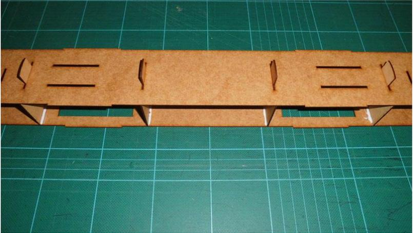
Die Unterdachplatte wird weiter vervollständigt mit der Verklebung von Stützträgern, entlang der Mittespannen.
