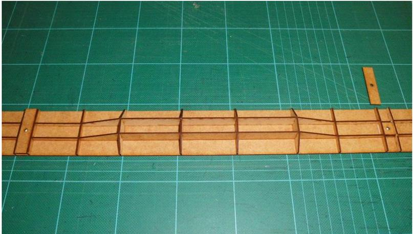
Die Pufferplatten werden auf die Pufferbohle geklebt und
