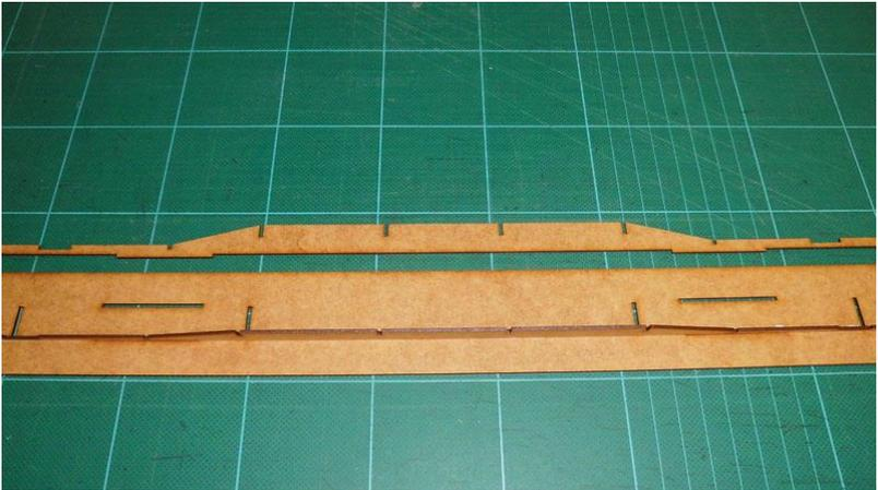
Die Mitte Querträger werden mit ihren Aussparungen montiert in die Schlitz der Längsträger.
