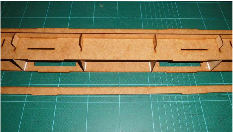
Die Stirnseiten werden angeklebt und zwischen die Dach-Stützträger kommen auch die Eis Lück-Spannten.
