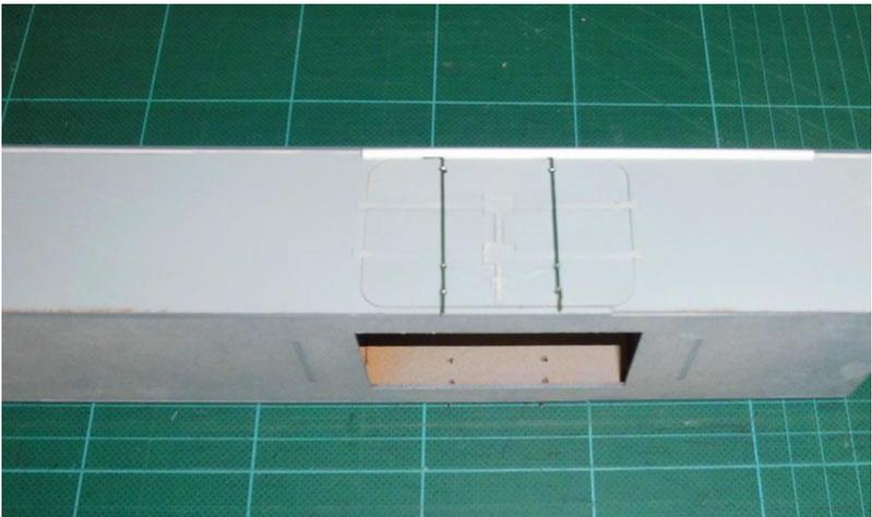
Zusätzlich worden noch die Schiebe Profilen angeklebt für die Schiebetüre und die Türstopfe.
