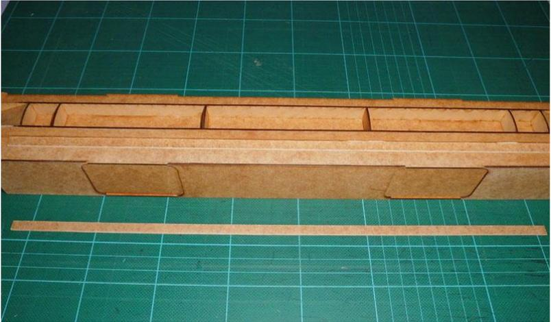
Das Dach ist mit 3 separaten Kunststoff T Profil Streifen (15x10 mm) gemacht worden entlang der Dach-Struktur:
