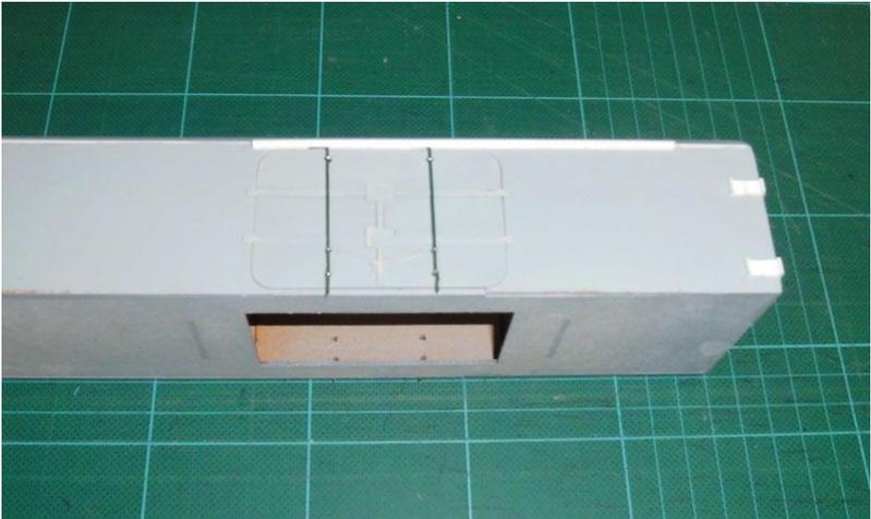
Nach Grundierung wird das Gehäuse in Verkehrs Weiß angestrichen (Ral 9016)
