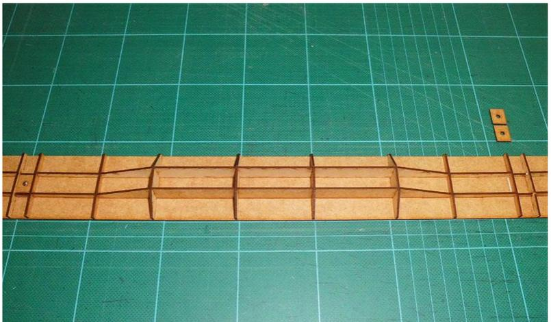
Dazu werden die Drehgestell Trägerplatten geklebt.
